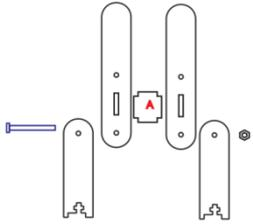
1.-Arma las piezas como se muestra en la figura utiliza el tornillo de 3x30. Coloca tus 4 juegos ya armados en la base, puedes usar los tornillos de 3x10 para fijarlos o un poco de kola loka.
