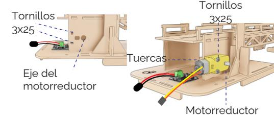
**17** Coloca la POB-CH en el eje del motorreductor
