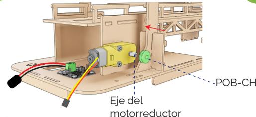
**18** Conecta los jumpers del motorreductor al Puente H
