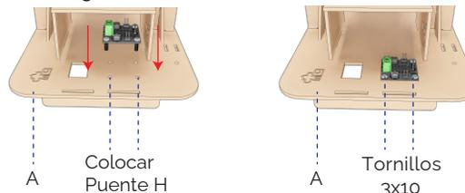
**14** Conecta el broche para pila en la terminal verde del puente H.
