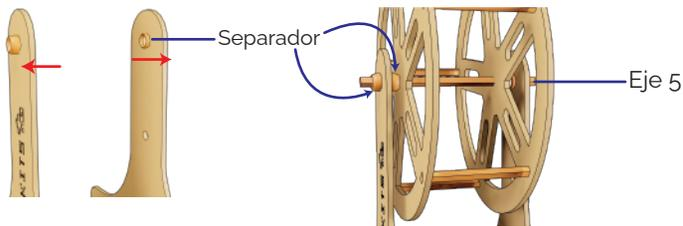
**4** Coloca la pieza ENB-G en el lateral de la pieza L2 en el eje, fijándolo con un OP y la pieza PIB-CH del lado opuesto (L1).
