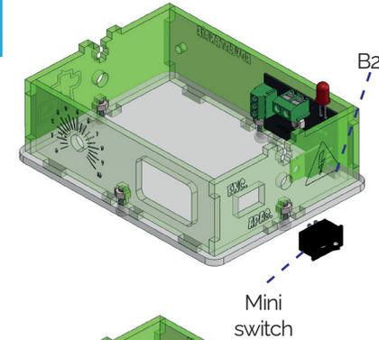
7 En los orificios circulares de las piezas B1 y B2, coloca por fuera los conectores banana hembra. Fíjalo con su tuerca.
