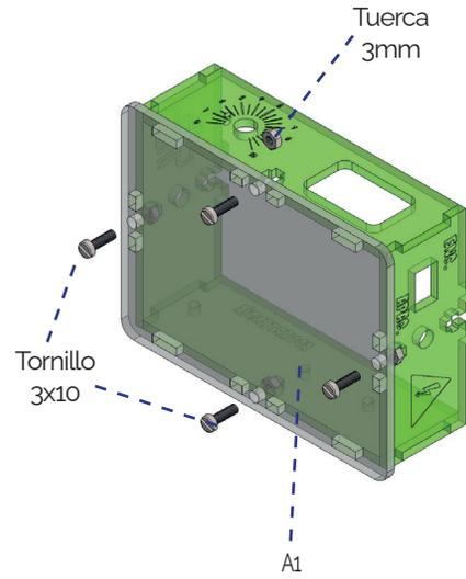
5 Coloca la tarjeta en la pieza C2. Inserta por fuera un tornillo de 3x10 y sujeta con una tuerca de 3mm.
