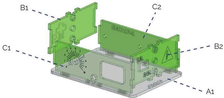
4 Inserta los tornillos de 3x10 por debajo de la pieza A1. Sujeta los tornillos con las tuercas de 3mm.
