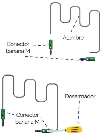
19 Inserta los conectores banana macho a los conectores banana hembra de las piezas A1 y B2.
