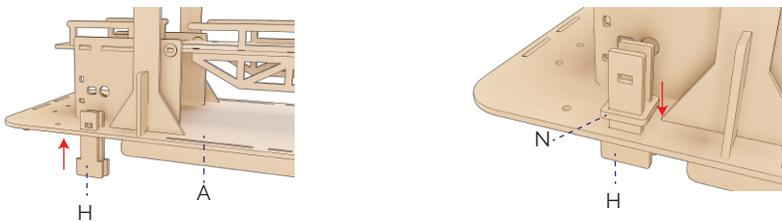
**B** Entre las piezas H coloca la POA-MED usando un eje y fíjala con 2 opresores.
