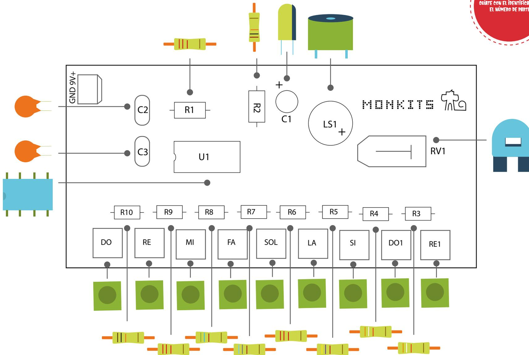
Suelda los componentes a la tarjeta guiándote con el identificador y el número de parte, asegúrate que los componentes están en la posición correcta apoyándote de la información en la primer pagina.
